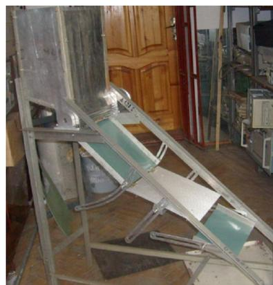
Рисунок 2 – Общий вид сепаратора для разделения сыпучих материалов
