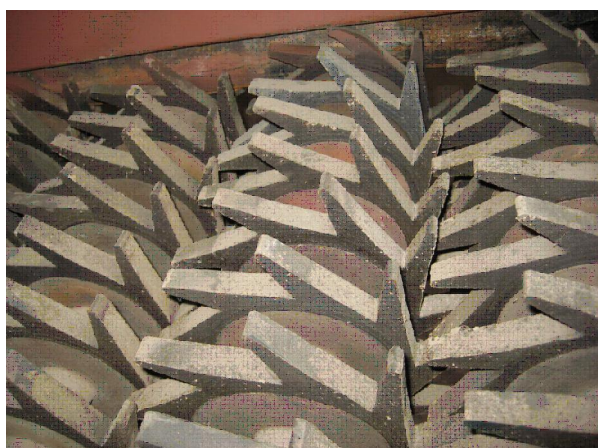
Рисунок 2 – Сепаратор почвы с резиновыми пальчатыми роторами
