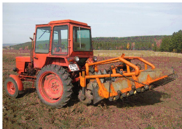
Рисунок 1 – Общий вид агрегата: трактор Т-25А и двухрядный картофелекопатель
