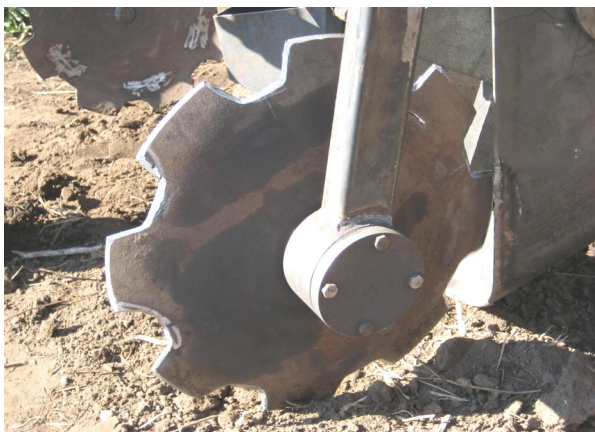
Рисунок 6 – Диски с трапецеидальными вырезами
