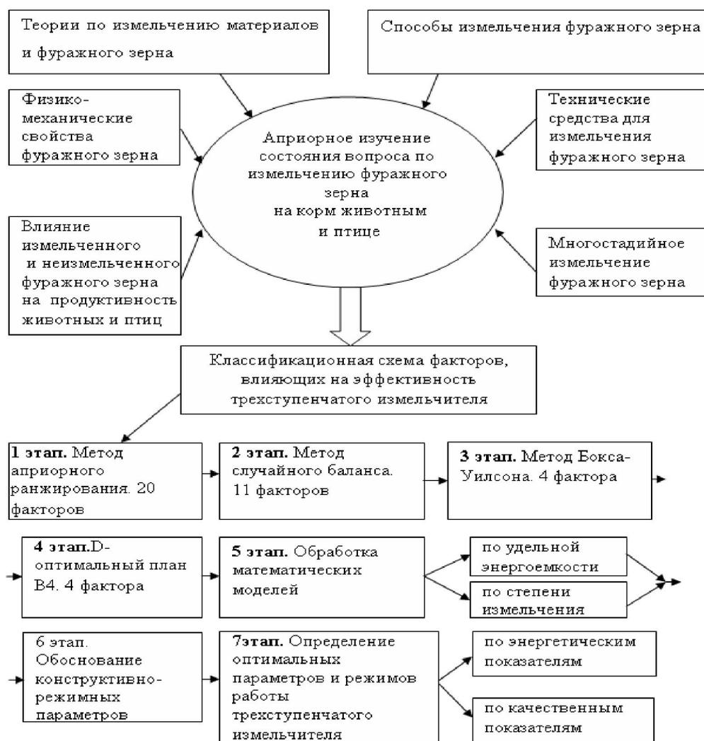
Рисунок 1 – Структурно-логическая схема системного подхода к экспериментальным исследованиям трехступенчатого измельчителя
